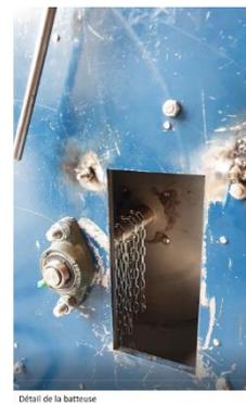
Nous avons trouvé une solution qui a permis d'y pallier, en remplaçant les pales initialement en caoutchouc par des chainettes métalliques (voir photo ci-contre)
